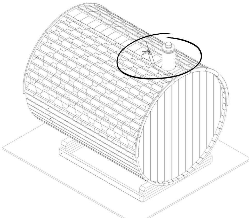
Schritt 68 A. Ziehen Sie nun die Gummikappe über den Schornstein und verwenden Sie bei Bedarf WD40 oder Wasser als Gleitmittel. Drücken Sie die Gummikappe fest auf das Bitumen-Set und schrauben Sie es mit (12x) 4x20-Schrauben am Dach fest.
