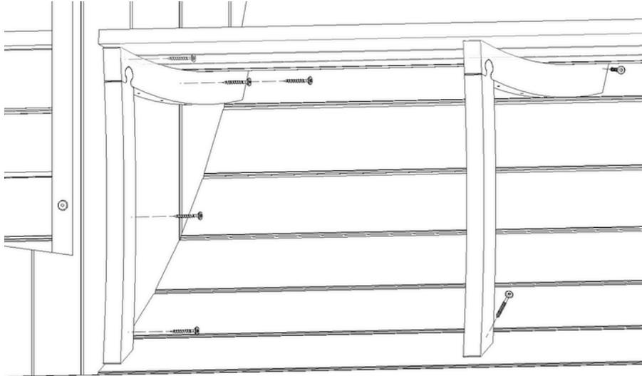
Schritt 45 B. Schrauben Sie das Bein mit (4x) 4,5x60-Schrauben an der Fensterseite fest. Positionieren Sie diese Schrauben in der Nähe der Schalung, wie im Bild unten gezeigt.
