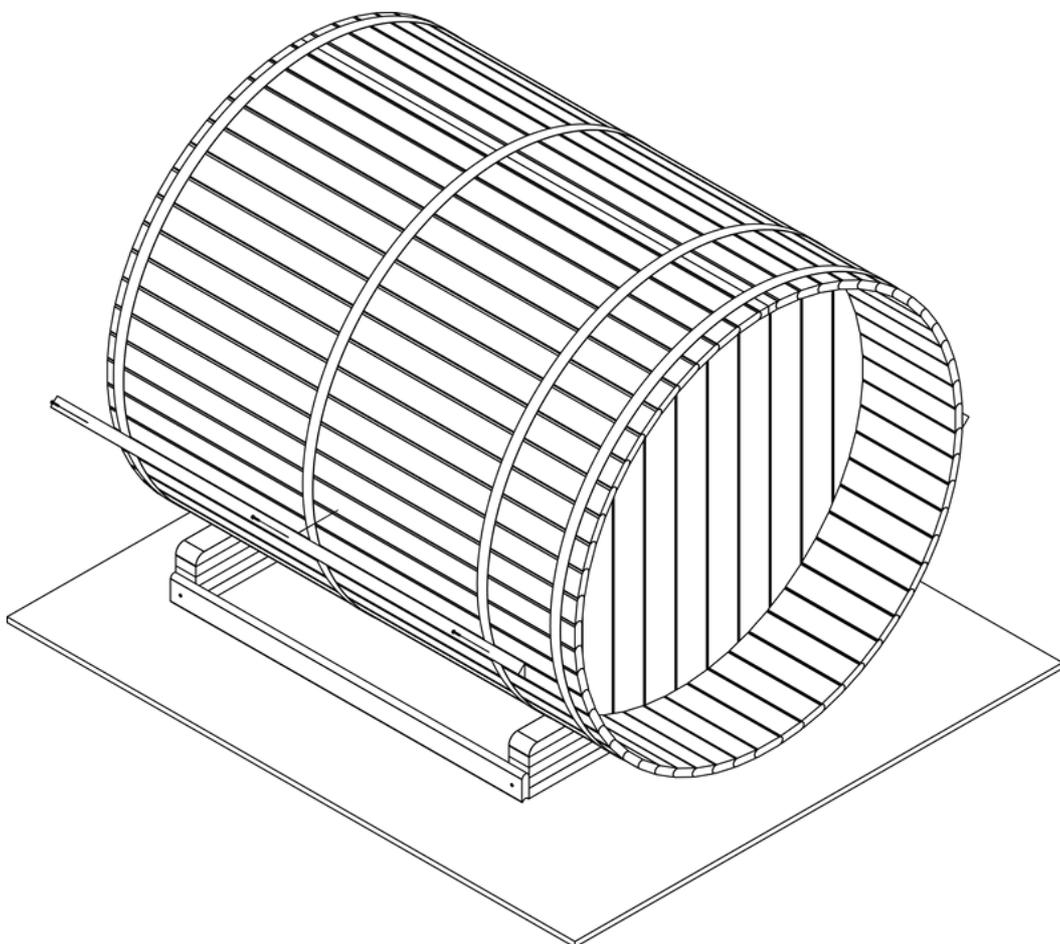
Schritt 34. Wenn Sie sich für Dekobögen entschieden haben, bohren Sie es mit einem 3-mm-Bohrer auf die unten angegebenen Abmessungen vor.
