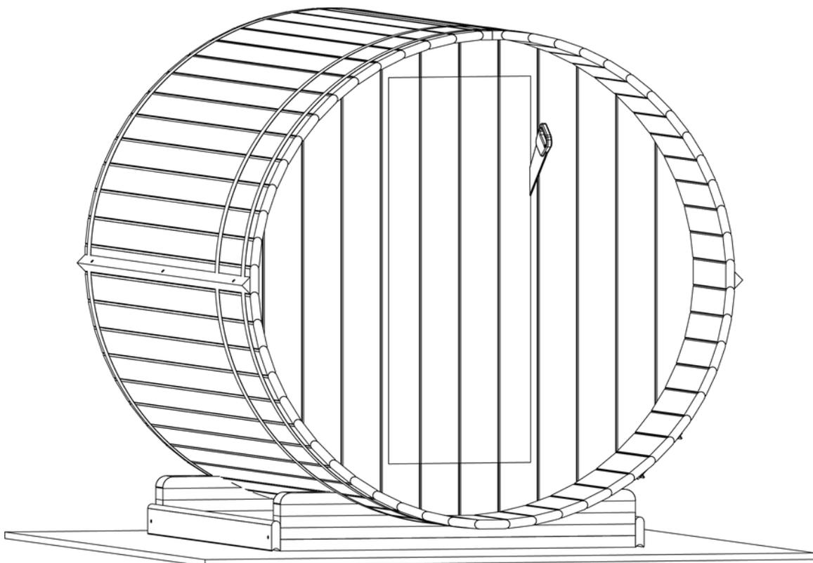
Schritt 40. Schrauben Sie (6x) 5x100 Schrauben vom Türloch in die Wand. Um die Wand zu stärken.
