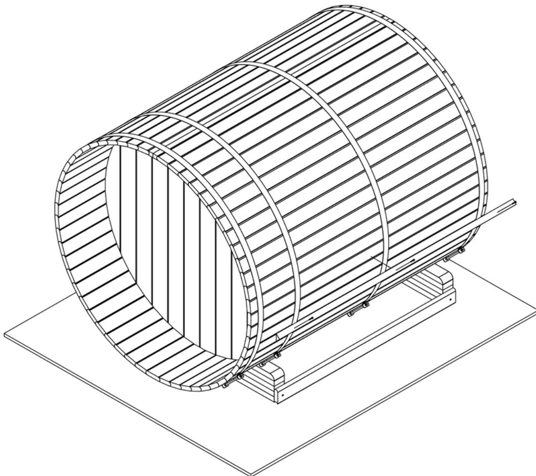
Schritt 33. Befestigen Sie den Regenabweiser auf der linken Seite mit (3X)4,5x60-Schrauben an der Schalung. Etwa jeden Meter eine Schraube anbringen. Spanngurte nicht durchschrauben.
