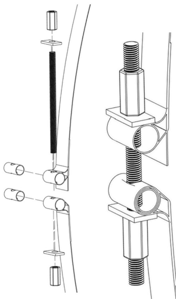
Schritt 30. Nachdem nun die Spanngurte dafür sorgen, dass die Schalungsträger an Ort und Stelle bleiben, entfernen Sie die Schrauben in der Schalung bis zum Standfuß.
