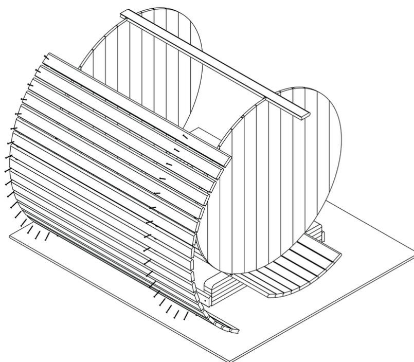
Schritt 20. Platzieren Sie die rechten Halbmondprofile Stück für Stück auf der rechten Seite und verschrauben Sie diese mit (2x) Schrauben 4,5x60 pro Profil. Positionieren Sie die Schrauben in der Mitte der Nut. Tun Sie dies bis etwa 2/3 der Höhe der Sauna. Stellen Sie mithilfe eines Gummihammers sicher, dass jedes neue Halbmondprofil gut zum vorherigen Profil passt.
