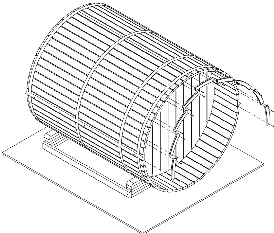
Schritt 36. Befestigen Sie nun die Bögen an der Rückseite. Beginnen Sie oben in der Mitte und verwenden Sie (2x) 4x60 Schrauben pro Stück.
