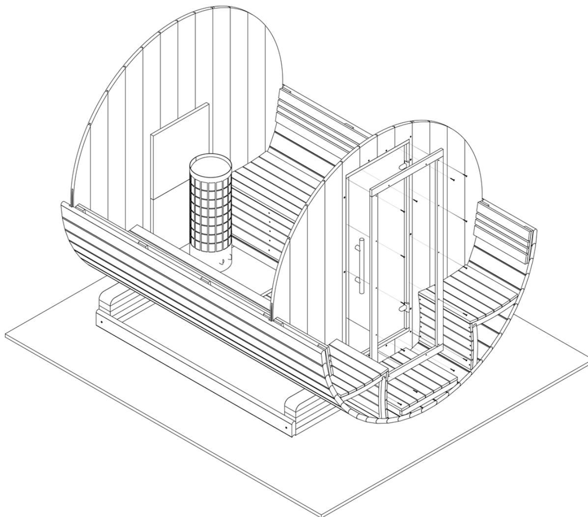
Schritt 76. Schrauben Sie die Montagebalken ab.
