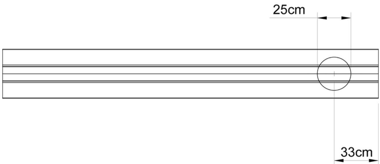
Schritt 38. Schneiden Sie den Kreis mit einer Stichsäge aus und entfernen Sie das ausgeschnittene Holz.
