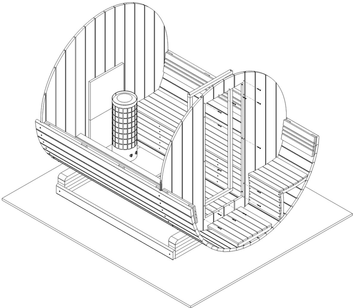
Schritt 73. Setzen Sie nun die Tür in das Loch und den Justierahmen ein. Diese kann sich leicht verkanten. Klopfen Sie die Tür daher vorsichtig mit einem Gummihammer in den Rahmen.
