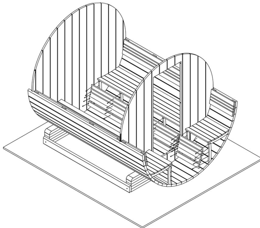
Schritt 50AB. Legen Sie die Böden ein. Der 90 cm lange Boden liegt an der Rückwand. Eine Verschraubung der Böden ist nicht erforderlich.
