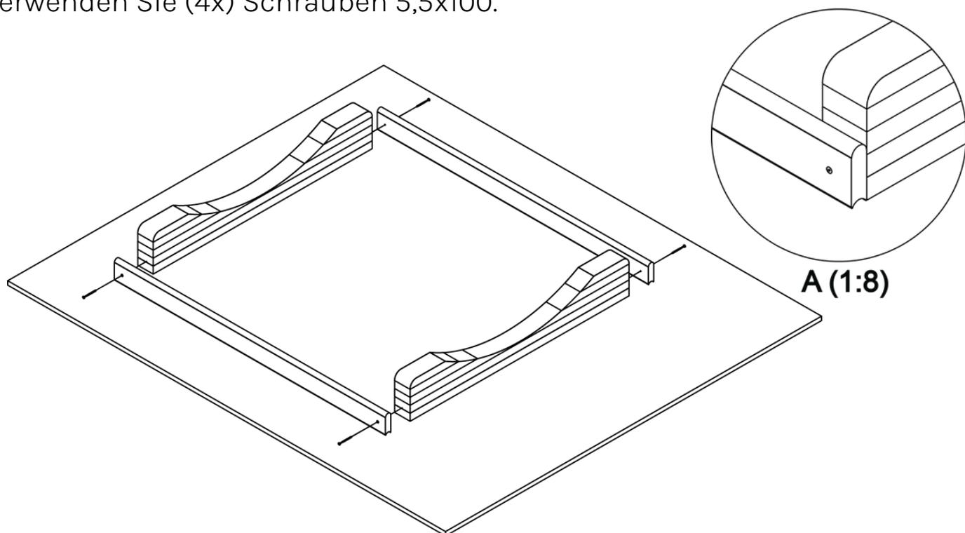
Schritt 4. Platzieren Sie das mittlere Vollmondprofil in der Mitte der Standfüße und achten Sie darauf, dass der Rahmen quadratisch ist. Die Innenseite des Schlitzes liegt auf derselben Ebene wie die Außenseite des Fußes.
