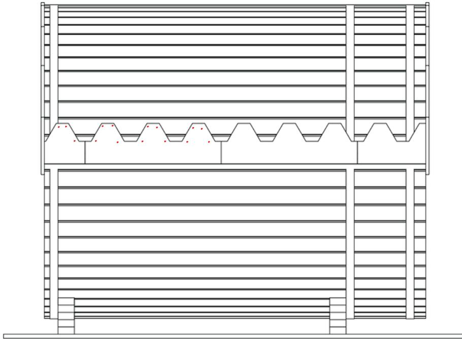
Schritt 57. Beginnen Sie nun mit der zweiten Reihe und drehen Sie diese um. Richten Sie die Unterseite der Schindeln an der vorherigen Reihe aus. Kleben Sie den Klebestreifen auf und schlagen Sie erneut Asphaltnägel in die roten Punkte ein. (Wenn Sie von den Punkten abweichen, können die Asphaltnägel sichtbar sein.)
