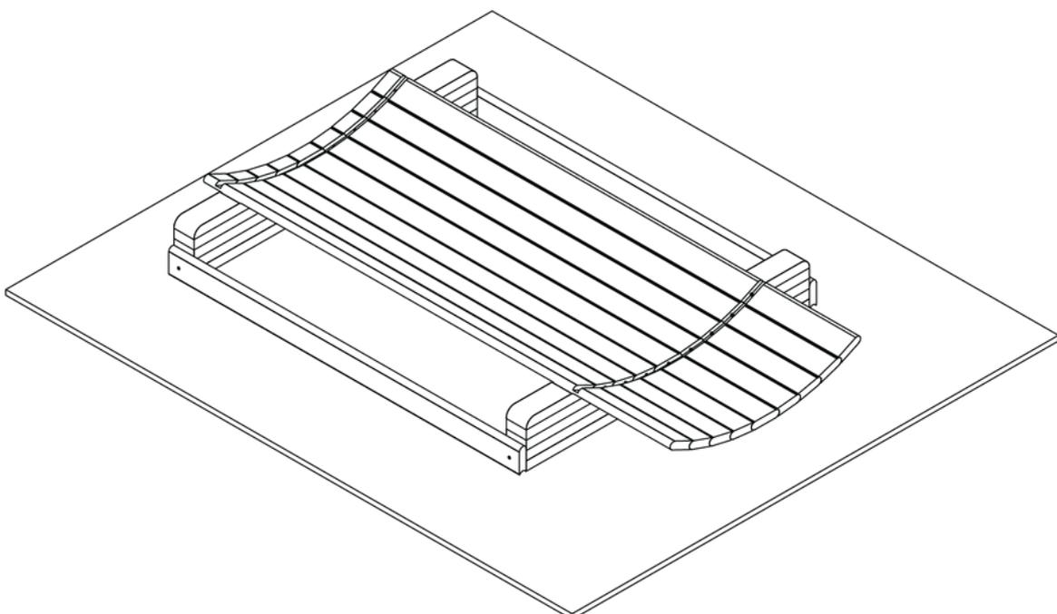
Schritt 8. Bohren Sie in die Schlitz jedes Profils ein Loch mit 10 mm Durchmesser in der Mitte der Außenwand. Tun Sie dies sowohl für die vordere als auch für die hintere Nut, also zweimal pro Profil.
