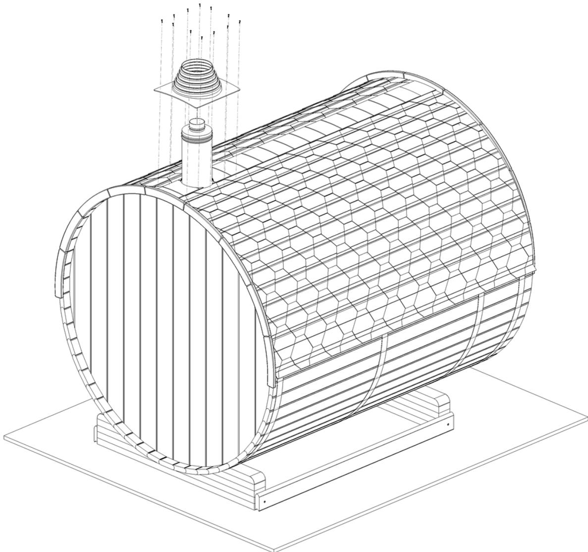
Schritt 69 A. Ziehen Sie nun eine mitgelieferte Schlauchklemme um die Gummikappe und das Rohr fest.
