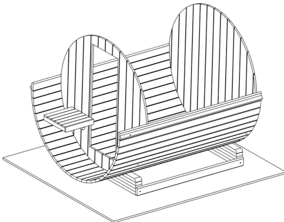
Schritt 45CD. Schrauben Sie das Bein hinter der Bank mit (2x) 4x20 Schrauben fest
