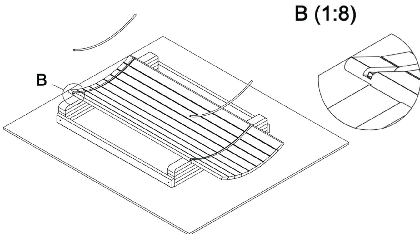
Schritt 10. Platzieren Sie den mittleren Teil der Vorderwand in der Nut. Stellen Sie sicher, dass es am Boden der Rille sitzt und sich in der Mitte befindet. Der Pfeil sollte vorne sein und nach unten zeigen.
