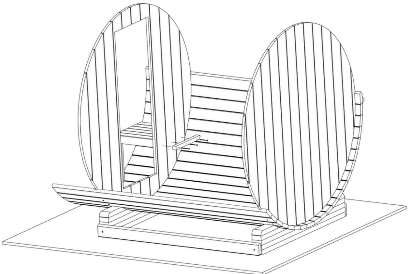
Schritt 49C. Stellen Sie die große Bank auf die beiden Stützen
