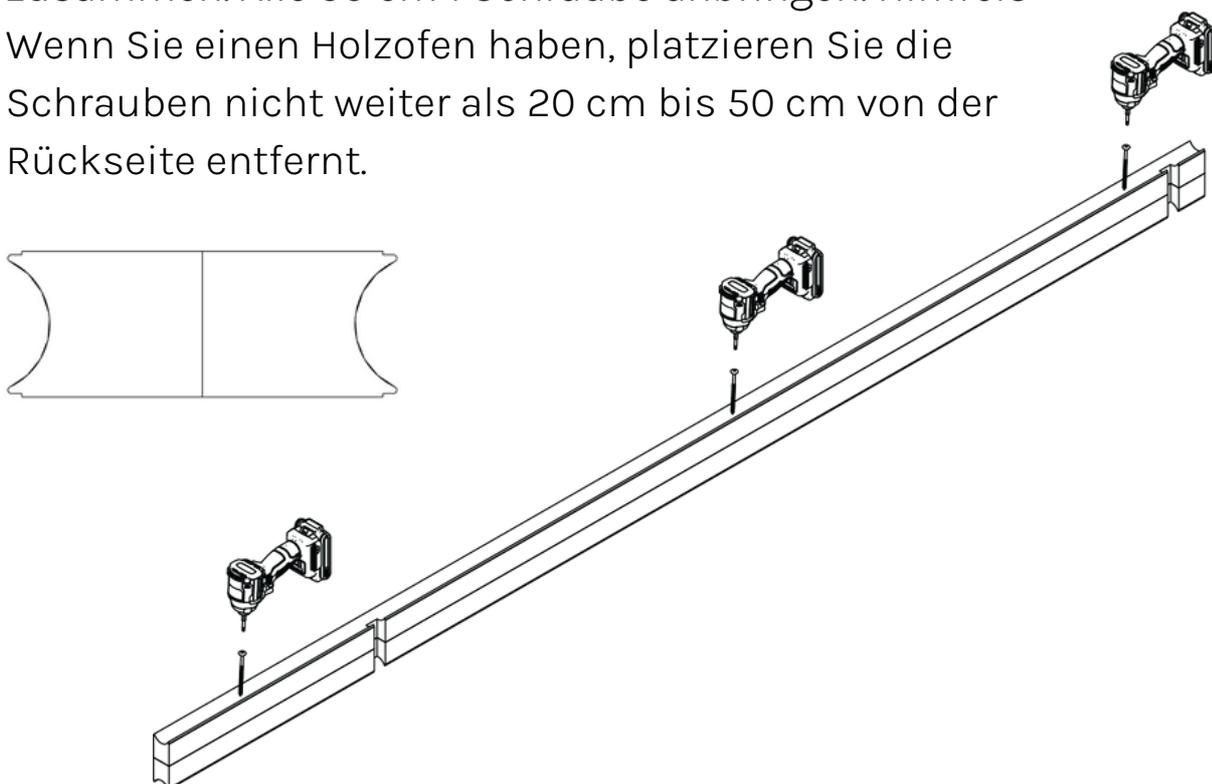
Schritt 28. Platzieren Sie das zuletzt erstellte Doppelsichelprofil und positionieren Sie es bei Bedarf mit einem Gummihammer.
