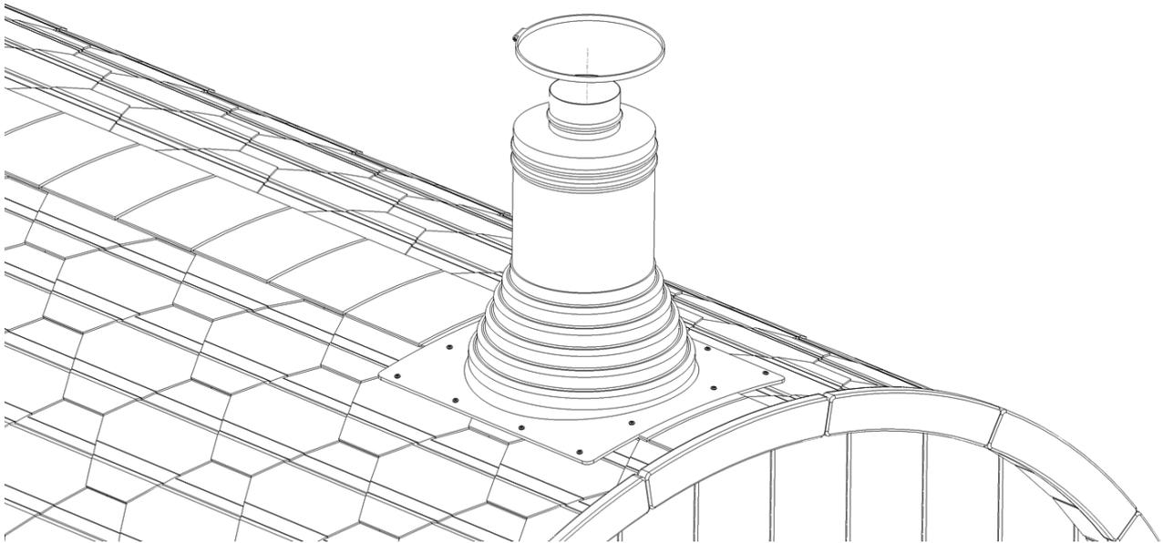
Schritt 70 A. Zum Schluss legen Sie ein Stück Rohr und eine Regenhülle in den Schornstein.
