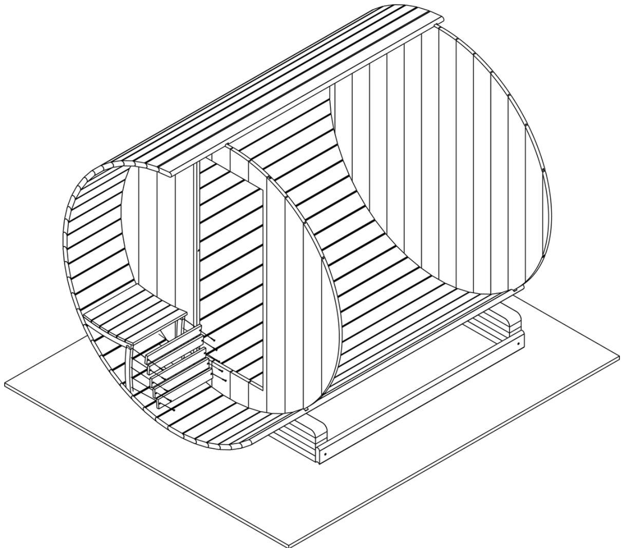
Schritt 44 A. Platzieren Sie die Innenbank und schrauben Sie sie mit (6x) 4x50-Schrauben links und rechts an der Wand fest. Schrauben Sie jedes Bein mit (2x) 4x50-Schrauben an die Schalung, Schrauben Sie es diagonal in das Bein, wie im Bild unten rechts gezeigt.
