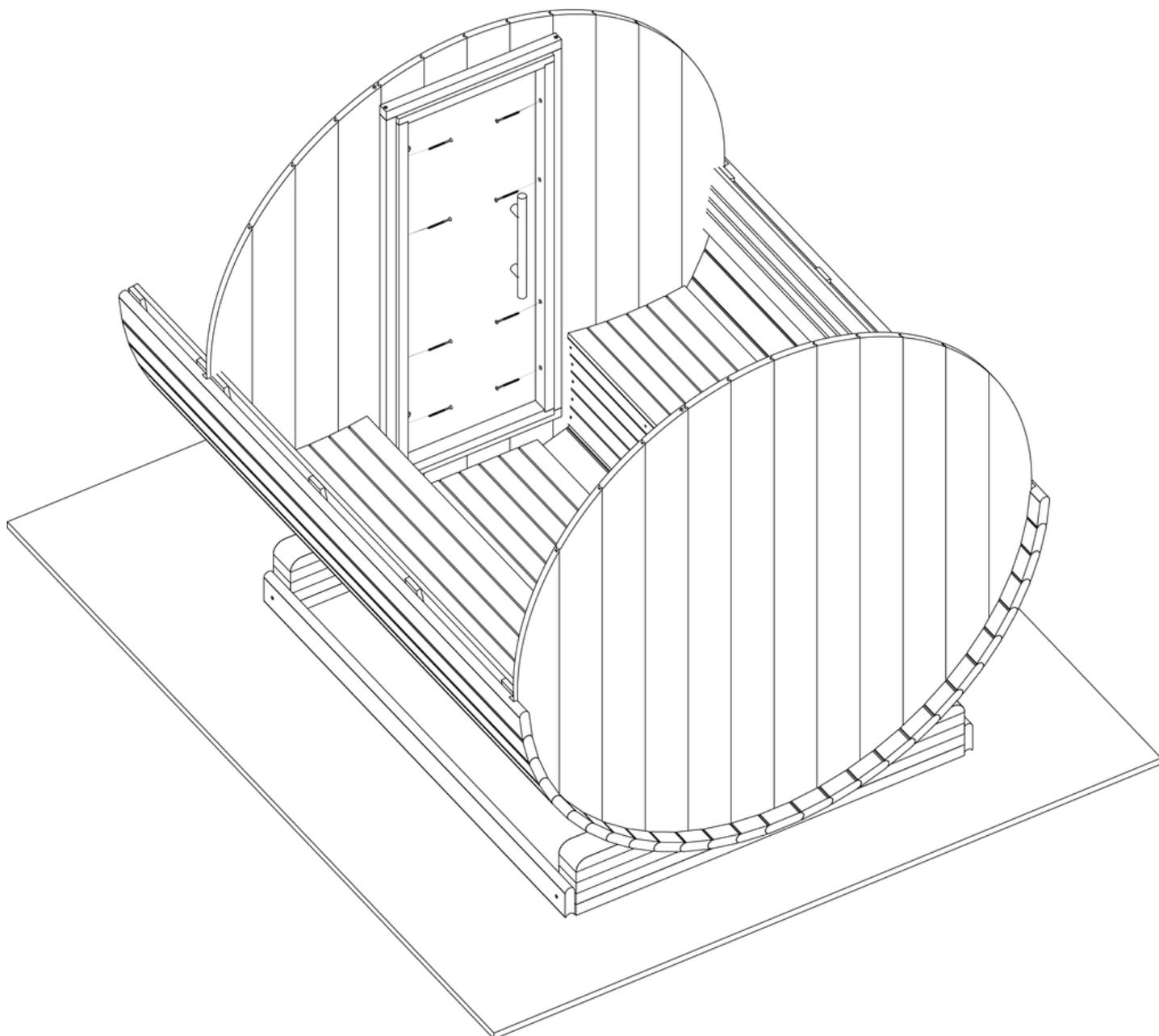
Schritt 75. Schrauben Sie die Abschlusslatten an die Wand rund um die Tür. Verwenden Sie dazu (12x) 3,5x40 Schrauben. 4 auf der langen und 2 auf der kurzen Seite.
