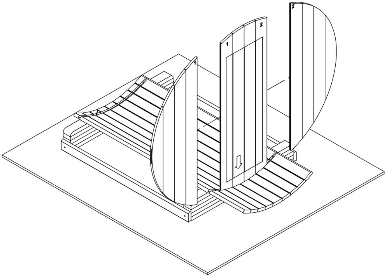
Schritt 13. Schrauben Sie die Seitenwände an die Mittelwand.
