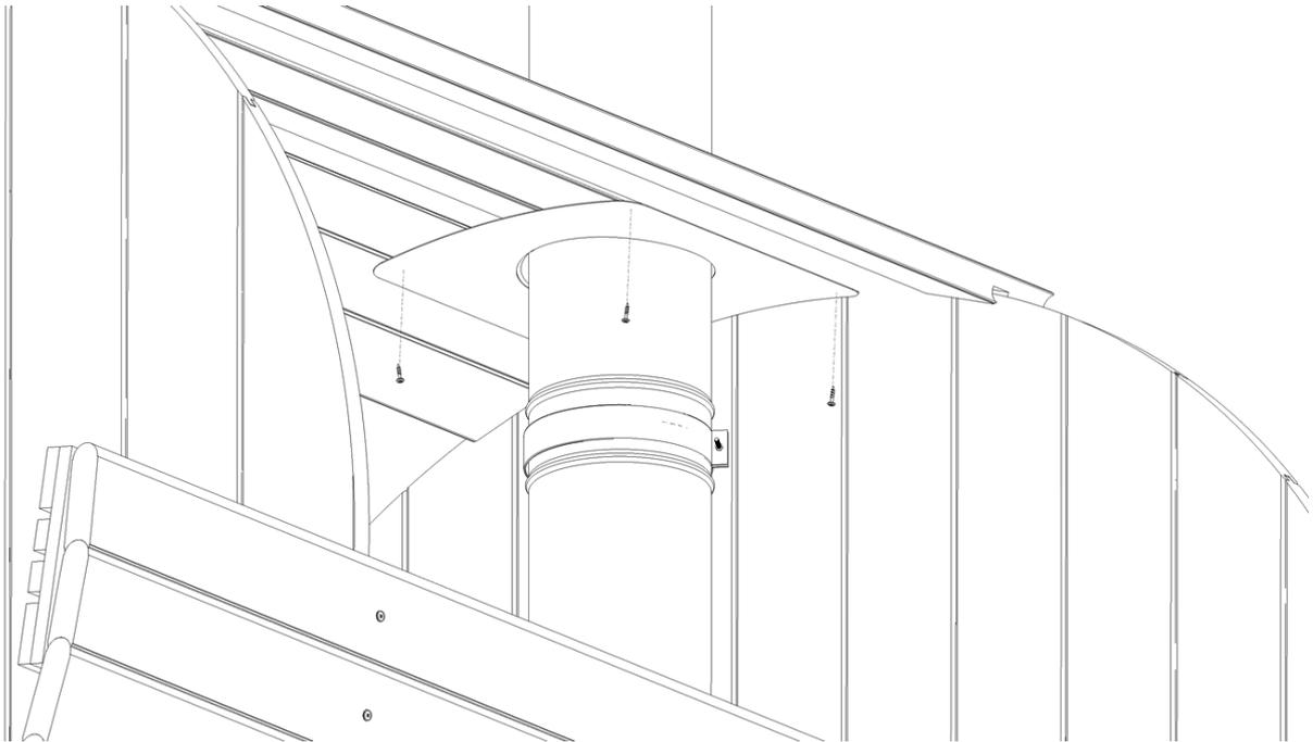
Schritt 67 A. Versiegeln Sie eine Leitung um den Schornstein rund um das Dach mit einem Bitumendichtmittel. Stellen Sie sicher, dass es etwas kleiner als die Gummikappe ist.
