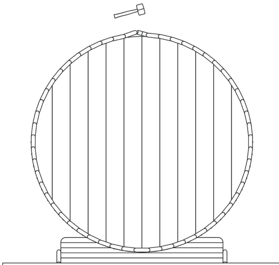
Schritt 29. Installieren Sie die Spanngurte und achten Sie darauf, dass sie sich neben den Schrauben befinden. Ziehen Sie die Spanngurte handfest an, sodass sie an Ort und Stelle bleiben, aber noch nicht fest sitzen.
